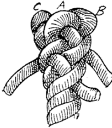
Illustration 9: Endspleiss in Arbeit
