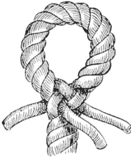
Illustration II: Anfang eines Augspleisses
