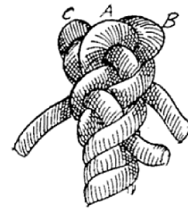
Illustration 9: Endspleiss in Arbeit
