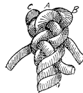
Illustration 9: Endspleiss in Arbeit
