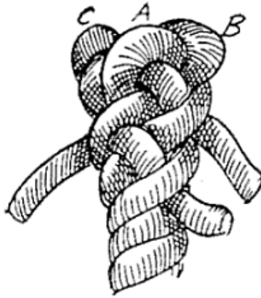
Illustration 9: Endspleiss in Arbeit
