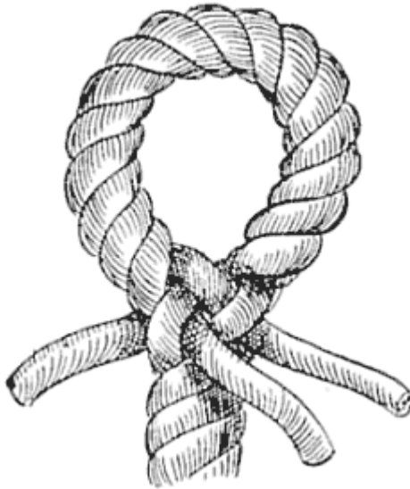
Illustration II: Anfang eines Augspleisses
